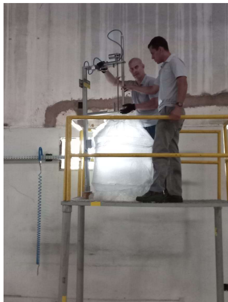
Figura 8. Modelo em acrílico com lança para injeção de ar comprimido.
